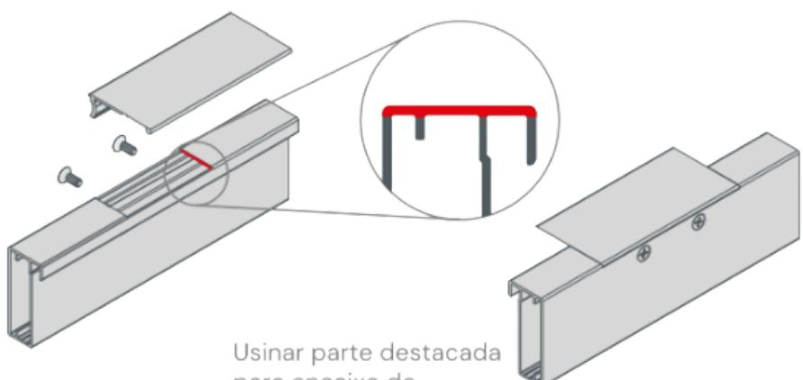
Usinar parte destacada para encaixe do puxador. Usinagem deve ser do tamanho do puxador.
